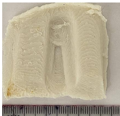
Рис. 2. Модель, изготовленная с помощью пластика ABS.
