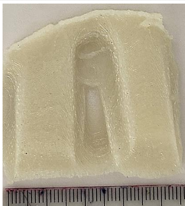
Рис. 3 Модель, изготовленная с помощью пластик PLA.
