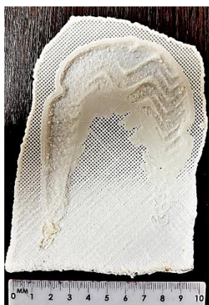
Рис. 5. Полимерная модель следа каблучной части обуви, изготовленная с помощью пластика ABS
