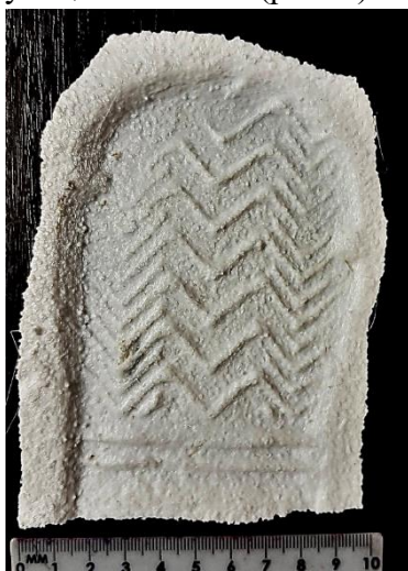
Рис. 4. Полимерная модель следа каблучной части обуви, изготовленная с помощью пластика PETG
