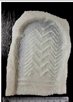
Рис. 6. Полимерная модель следа каблучной части обуви, изготовленная из пластика PLA
