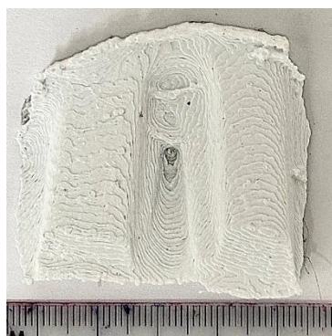
Рис. 1 Модель, изготовленная с помощью пластика PETG
